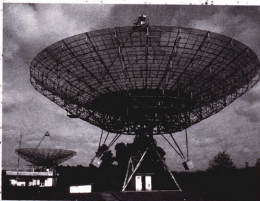
Figura 1a: Las dos antenas de 30m del IAR, a 100m una de otra, y la sala de control en medio.
