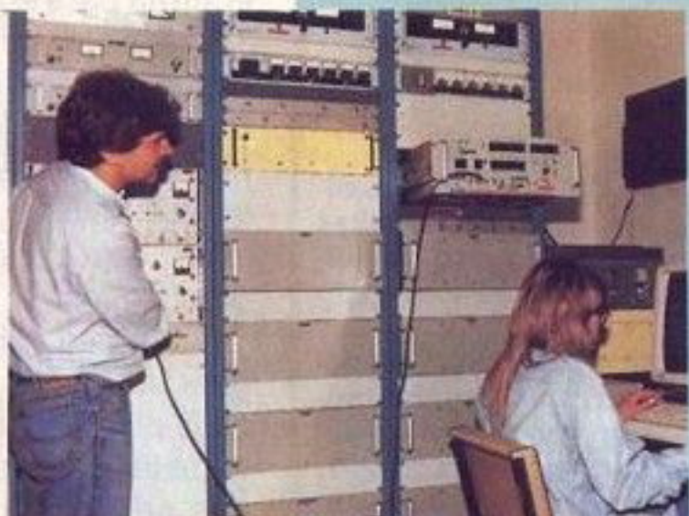
Gabinete del autocorrelador de 1008 canales. Este equipamiento es parte del telescopio de Arecibo, Puerto Rico, el mayor del mundo, cedido al IAR por convenio con la Natural Science Foundation. En la actualidad se lo considera el más potente del hemisferio Sur en resolución espectral.
